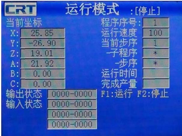
运行模式下，实时监控电机、输入、输出状态；
