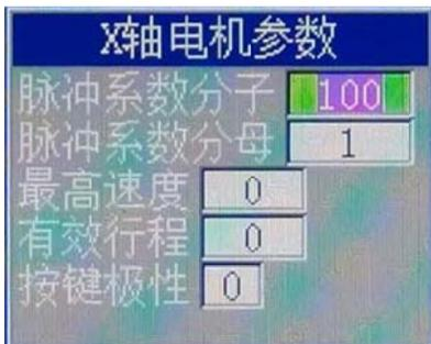
六个电机/轴各采用独立的参数设置，灵活适用各种应用场合；
