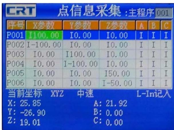
坐标采集支持绝对坐标、相对坐标的数据处理；
