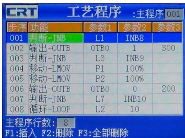
工艺文件与坐标信息采集采用分离式设计，工艺文件除实现电机运动控制：多轴直线插补、圆弧插补、圆弧与插补联动外，更可进行复杂的逻辑及运算功能；
