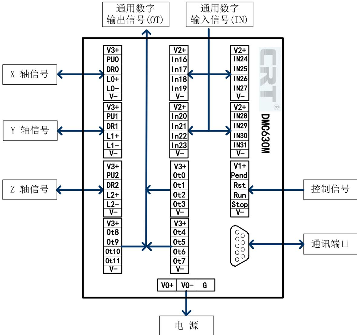
DMC640M/DMC650M/DMC660M 目前沿用相同底板，因此接口相同，不过，DMC640M：B 轴、C 轴无意义；DMC650M：C 轴无意义；
