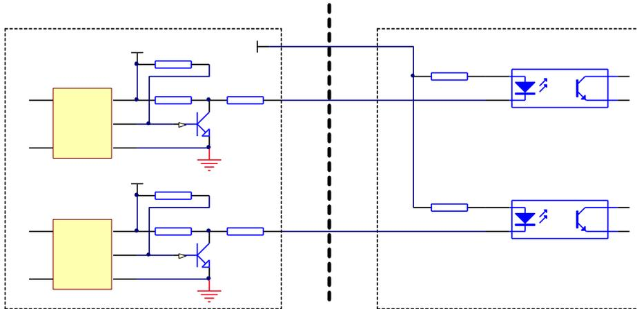
说明：信号输出为 24V，但内部已串电阻，直接对接 5V 接口驱动器；
