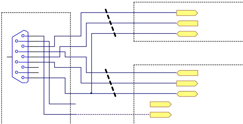
部分控制器扩展附件可以使用控制器供电，视具体情况，连接通讯端口 1、6 脚连线；
