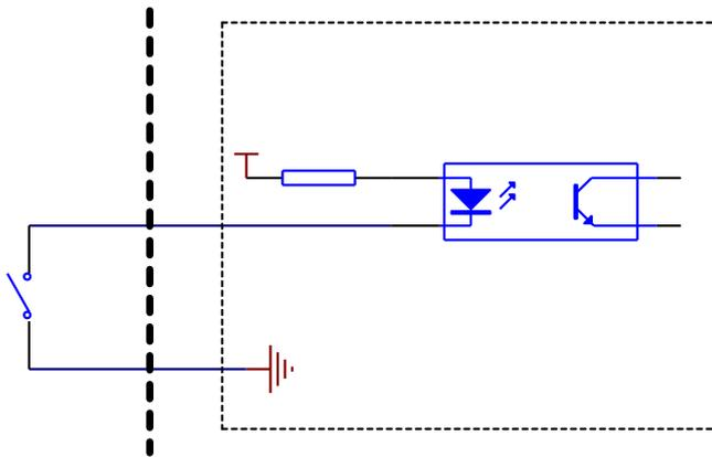
注意：1、控制器输入公共端 COM 为 V-(24V 地)；当系统与 PLC 通过 I/O 做状态通讯时，请注意确认 PLC 输出信号的公共端；
